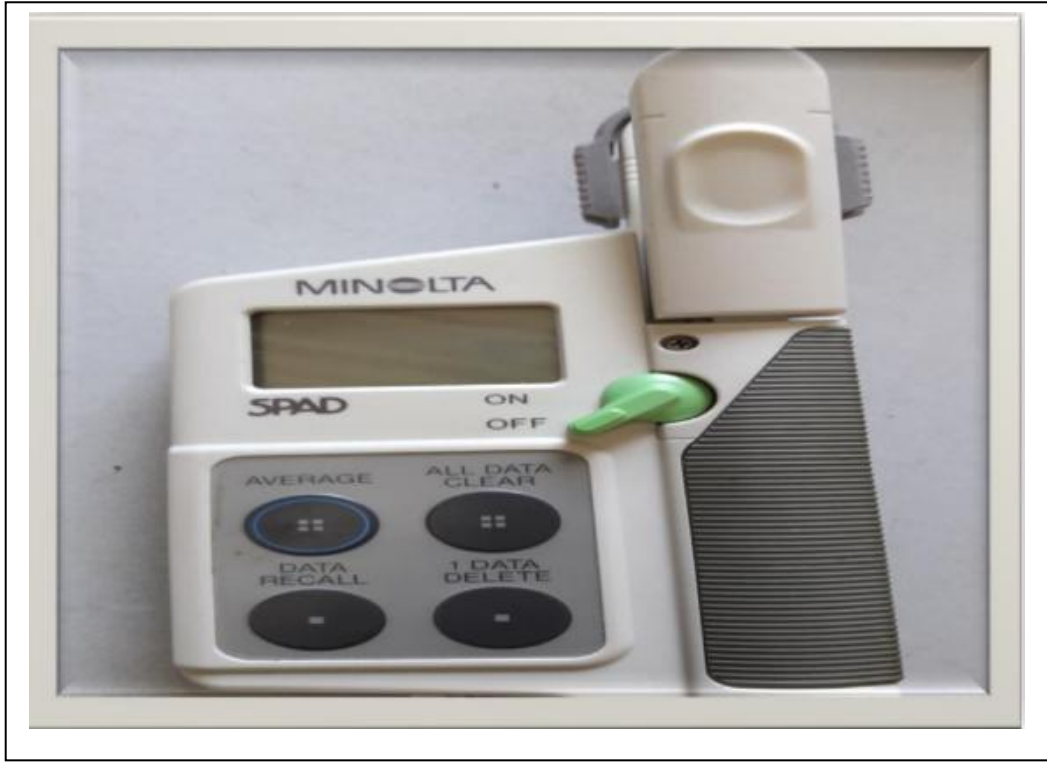
الشكل 16: صورة توضح جهاز SPAD لقياس الكروموفيل.
